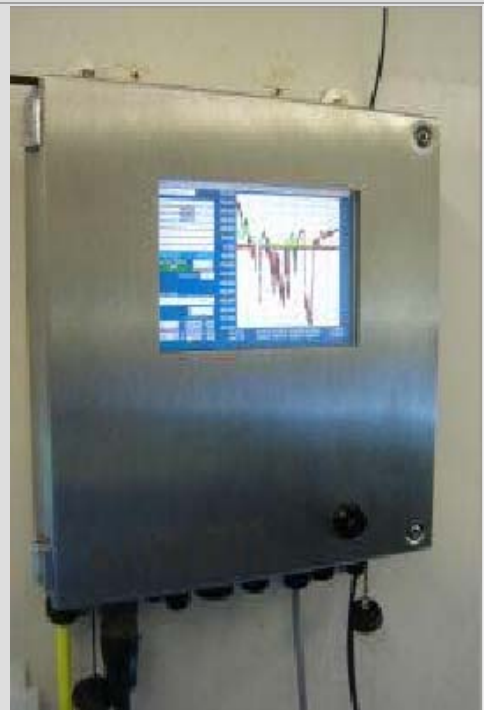
Fig.6: Controle-eenheid in het lab. Waterwaarden zoals nitraat, turbiditeit, TOC (total organic carbon) kunnen hiermee real-time worden gemeten (foto: Tim Wijgerde).
