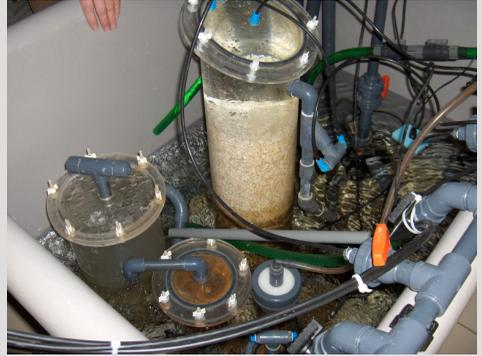
*Bak 2: De kalkreactor, Zeovit filter en 2 wervelbed filters.*
