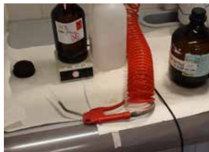
Met perslucht kan koraalweefsel effectief van het skelet worden verwijderd.
