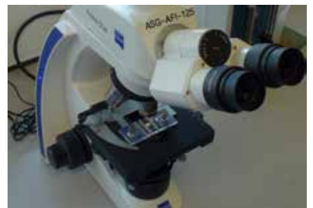
De hemocytometer wordt onder een microscoop geplaatst om de zoöxanthellendichtheid in het koraalweefselmonster te bepalen.
