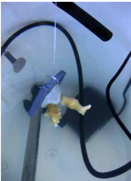
Een koraal wordt aan een draad opgehangen om onder water of drijvend te wegen.
