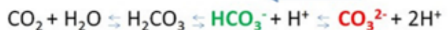
Figuur 3: Het CO 2 evenwicht. Als de pH daalt, zullen meer carbonaationen (afgebeeld in rood) omgezet worden in bicarbonaationen (in het groen). Dit zorgt voor meer 'ruimte' om nieuwe carbonaationen op te lossen, waardoor het moeilijker voor de koralen zal worden om hun skelet te bouwen (vergelijking door Tim Wijgerde).
