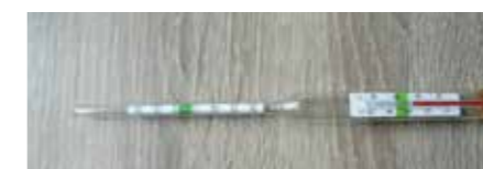
Deze SG meter is een drijvende dobber die de temperatuur aangeeft en de opwaartse druk van het water. Het groene gedeelte moet voor ongeveer de helft uit het water steken.
